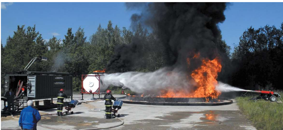
Полигон ООО НПО «СОПОТ». Отработка процесса ликвидации горения СУГ
