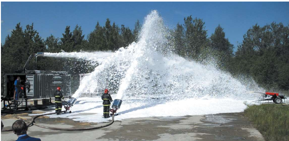
Полигон ООО НПО «СОПОТ». Исследование процессов пожаротушения СУГ и СПГ
